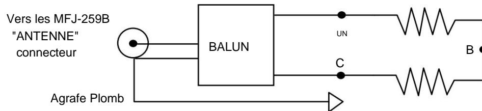
Un **balun de courant** correctement conçu est le type le plus efficace pour maintenir l'équilibre du courant. Il a la capacité de puissance la plus élevée et la perte la plus faible pour des matériaux donnés. Il devrait montrer un SWR faible sur toute la plage de fonctionnement du balun avec le fil de pince dans *l'une* des trois positions.
